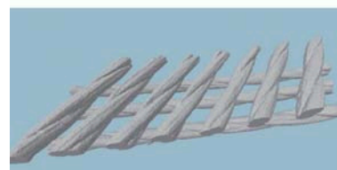
Abbildung 6: Risse in der Fadenlage eines Balgs, Transmissionsaufnahme (oben), Rekonstruierte Schnittansicht (Mitte), 3D-Rendering der Fäden (unten).
